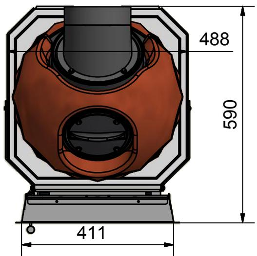
Verbrennungsluftanschluss Ø125 mm
